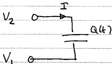
$$Q(t) = C(V_2 - V_1)$$
